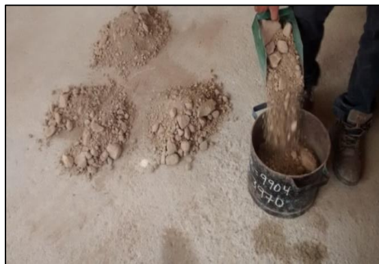
Figura.14 - Realizando Peso Volumétrico Seco Suelto
