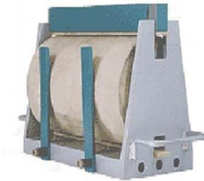
Figura 4: Prueba a Tension por compresion diametral.
