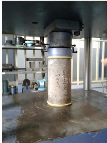
Figura 3: Ensayo de cilindros.
