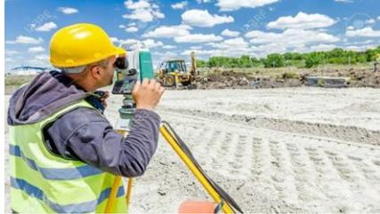
Es importante usar equipo de alta precisión y calibrado, para establecer una poligonal de apoyo con la precisión requerida, pues de esto depende la calidad de los trabajos topográficos. Para este proyecto se usó una Estación Total marca Sokkia modelo 230R, con precisión de 2 segundos y capacidad de medición sin prisma.
