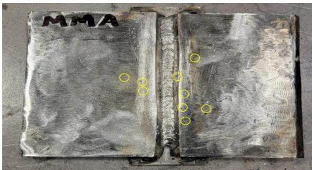
Fig.4 Los círculos amarillos nos muestran las impurezas que va dejando la salpicadura después del primer pase de raíz.
