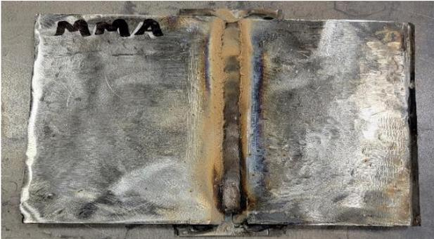
Fig.3 Placa después del primer pase de raíz.
