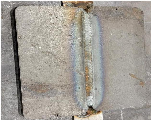
**Fig. 10** Resultados del proceso MIG en una sola pasada.
