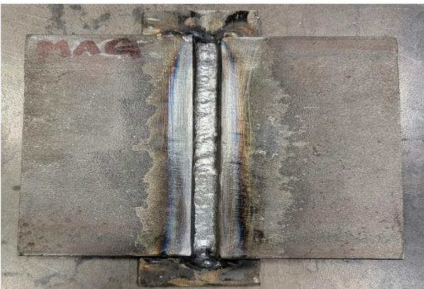
**Fig. 8** Limpieza después del primer pase de raíz
