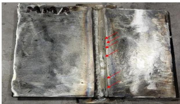
Fig. 5 Al llevar a cabo el desbaste nos encontramos con impurezas internar marcadas con una flecha roja y esto se tiene que desbastar hasta eliminarlas por completo antes de volver a soldar.
