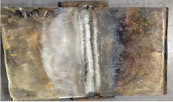
**Fig.6** Resultado obtenido con el proceso de soldadura de varilla (MMA).
