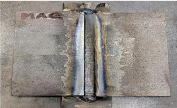
**Fig. 7** Después de realizar el pase de raíz.
