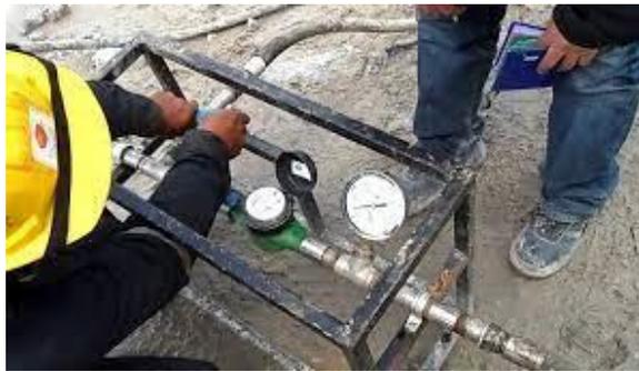
Figura 5. Prueba lugeon para determinar la Permeabilidad.
