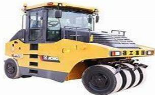
Fig.2 - Compactadores de ruedas neumáticas
