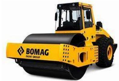
Fig.4 - Compactador vibratorio monocilíndrico
