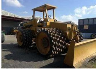
Fig.3 - Compactador de pata de cabra
