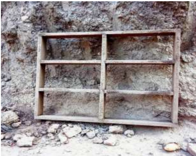
Fotografía 8: Molde de los tabiques.
