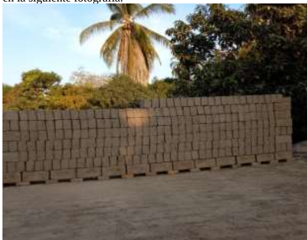
Fotografía 10: Bloques de tabiques ya en estado secos, y listos para su cocción.
