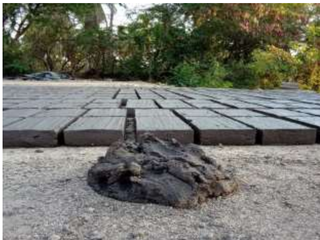
Fotografía 9: Bloques en proceso de secado.
