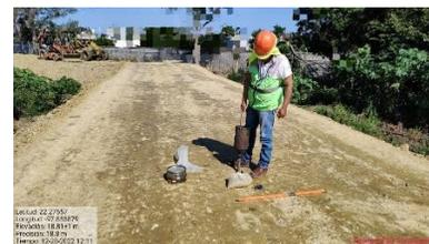
*Imagen 23 cubicación de vacíos mediante trompa de elefante*
