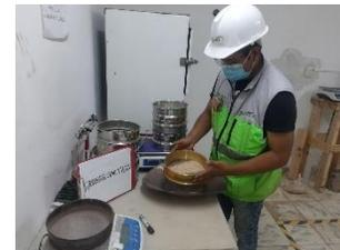
*Imagen 15 cribados de material por mallas correspondientes*
