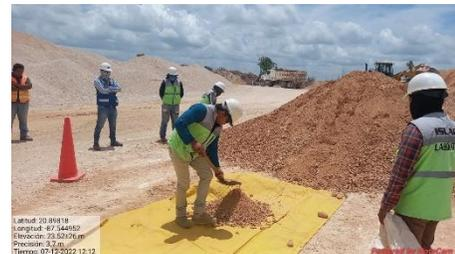
*Imagen 6 toma de muestra mediante cuarteo*
