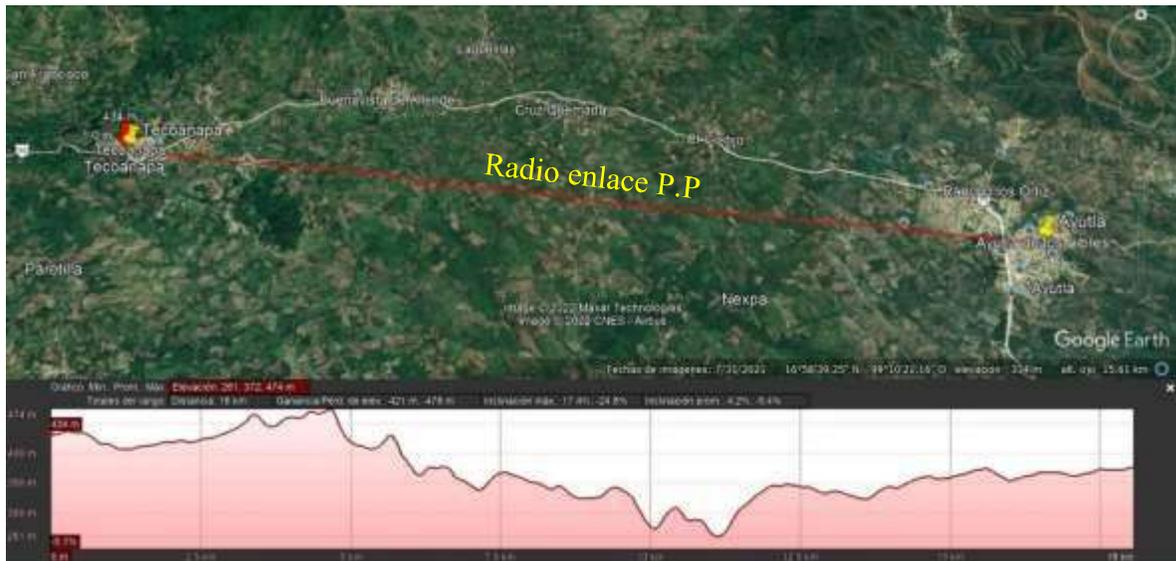
figura 4. vista grafica de el radioenlace con una distancia de 18 km
