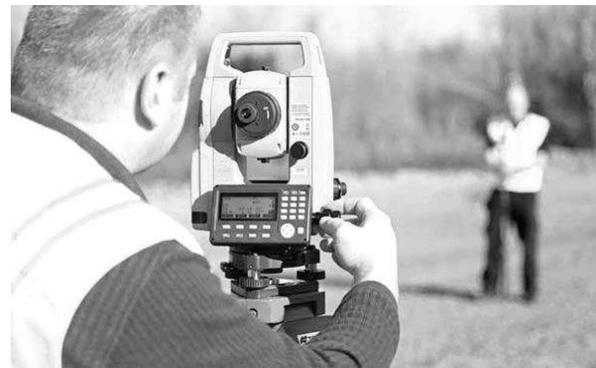
Figura 3.3. Estación total, aparato de precisión topográfico
