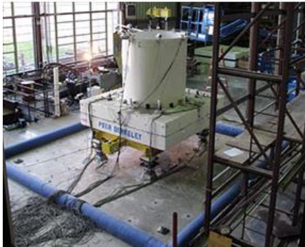
F figura 1. Mesa vibradora multidireccional de la University of California, Berkeley. Peso máximo de los modelos que pueden ser
