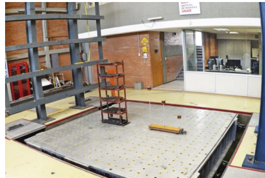
ensayados: 45.359237 t Figura 2. Mesa Vibradora del Instituto de Ingeniería UNAM, Peso máximo de los modelos que pueden ser ensayados: 20 t
