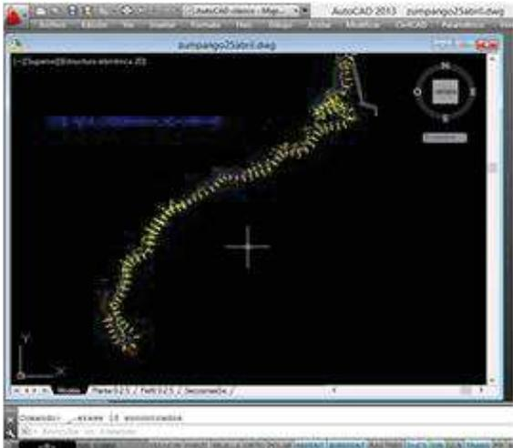
Figura 7. Planta de trazo de camino y levantamiento topográfico. (Producto de civilCAD)
