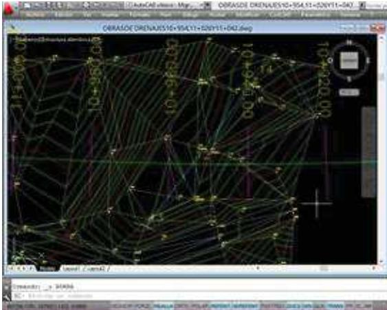
Figura 6. Triangulación y curvas de nivel de una obra de drenaje. (Producto de civilCAD).
