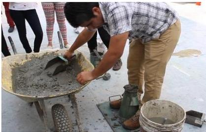
**Figura 19.** Prueba de llenado de cono Abram
