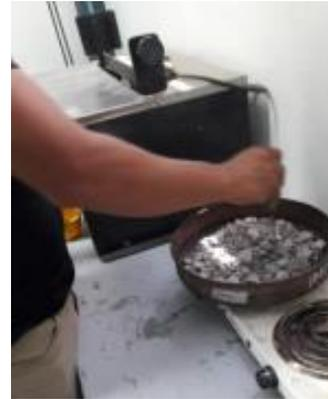
**Figura 12.** Secado de material por medio de una parrilla eléctrica.
