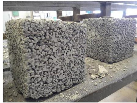
Figura 4. Estructura porosa de un concreto permeable
