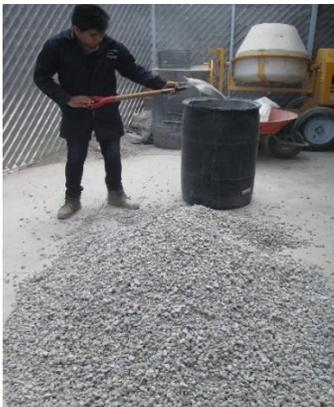
**Figura 11.** Secado natural de muestra de agregado reciclado
