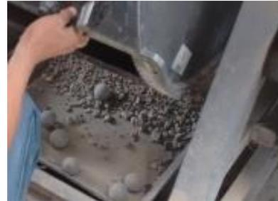
**Figura 17.** extracción de material junto a 11 esferas después de terminar 1000 rpm.
