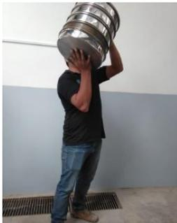
**Figura 16.** Distribución de agregado por medio de la agitación dos manos.
