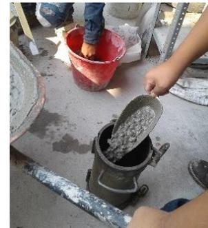
**Figura 22.** Llenado de molde metálico con concreto permeable
