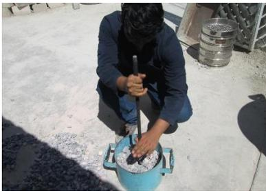
**Figura 15.** Compactación a cada un tercio de agregado con una varilla punta de bala.
