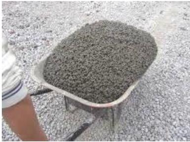
**Figura 18.** Concreto permeable elaborado con agregado reciclado en estado fresco.
