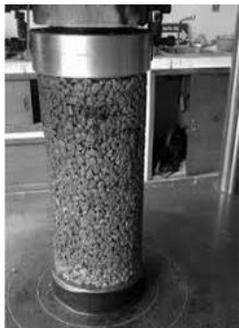
**Figura 23.** Ensayo a compresión simple de concreto permeable (edad de 3,7,14 y 28 días).
