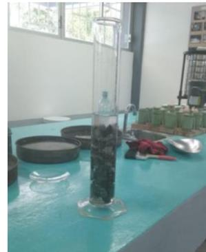
**Figura 13.** Probeta aforada con agua y agregado reciclado.
