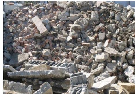
**Figura 9.** Muestra del agregado de la demolición, Edificio 1.
