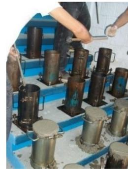
**Figura 2. Elaboración de cilindros de concreto (Alonso, 2013)**
