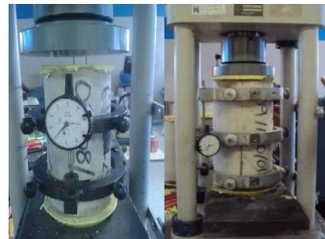
**Figura 3. Ensayo a compresión simple**
