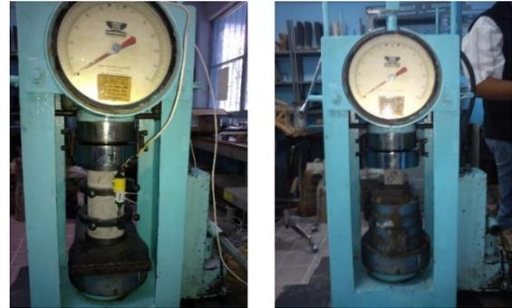
Figura 6. Probetas de mortero en máquina de ensaye a compresión
