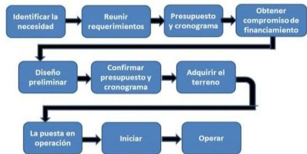
Figura 3: proceso que debe seguir durante la planeación del diseño de un Data Center.
